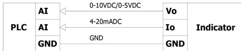
Analog output connection / Đấu nối ngõ ra tương tự
